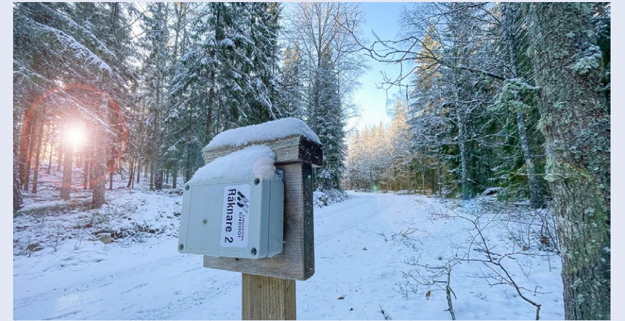
Besöksräknare i Strävaområdet, trådlöst uppkopplad genom IoT-nätet.
